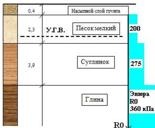
Рис. 16. Буровая колонка со схемой геологического напластования грунтов и с построенной эпюрой условного расчётного сопротивления основания ( R_0 ) по каждому слою грунта (см. ниже).
