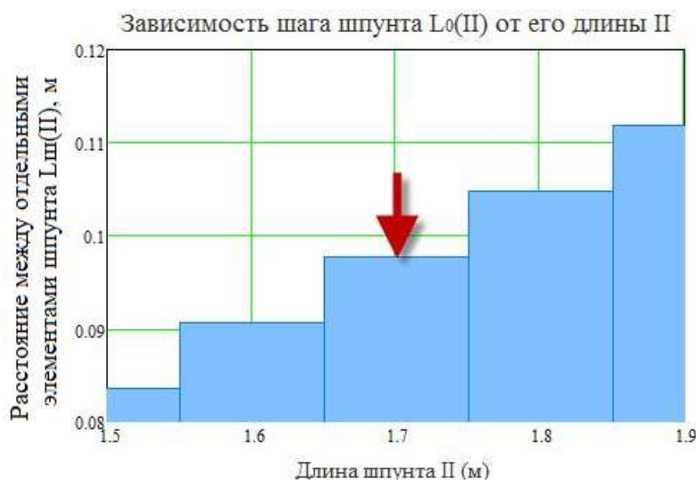
Рис. 6.8. Результаты решения по определению оптимального расстояния между отдельными элементами шпунта (шаг шпунта). Для шпунта длиной II = 1,7 м отдельные элементы шпунта (швеллер № 16) могут быть погружены с шагом L_{ш}(II) = 0,09 м
