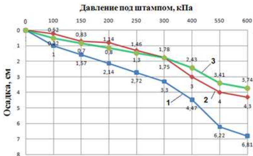
Рис. 5.20. Графические зависимости осадки штампа (0,8x0,6м) от прикладываемого давления. 1 – расчётная осадка, для штампа на естественном основании; 2 – измеренная осадка по результатам испытаний на уплотнённом выштампованными микро сваями основании; 3 – расчётная осадка, для штампа на уплотнённом выштампованными микро сваями основании
