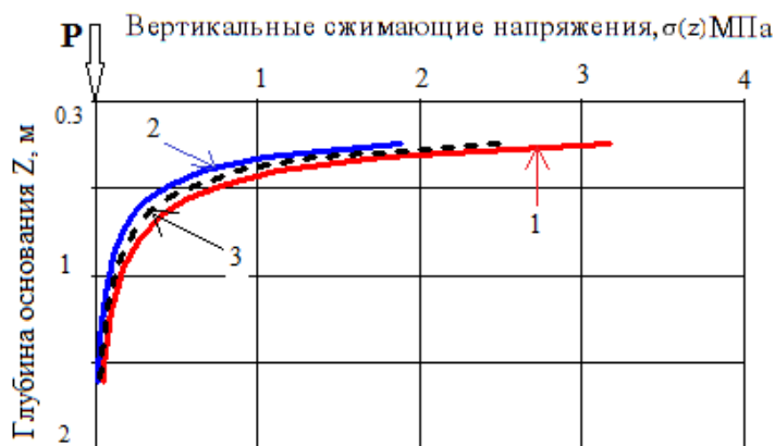
Рис. 7.2. Пример определения вертикальных сжимающих напряжений в грунте при действии сосредоточенной силы P на поверхности. 1 – напряжения по глубине основания без учёта его свойств ф. (7.1); 2- тоже для плотного песка (при e_0=0,5 ) ф. (7.7); 3 – тоже для глинистого грунта в тугопластичном состоянии ( \gamma=21 кН/м 3 ) ф.(7.7)
